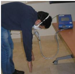
Un mal sellado entre el EPI y la piel permite que las partículas de 30 a 1.000 nm penetren de **7 a 20 veces más** por el sello facial que a través del filtro de una mascarilla autofiltrante N95.
